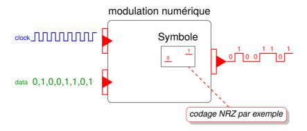
Le débit de sortie du codage dépend du rythme de l'horloge, c-à-d de sa fréquence.
