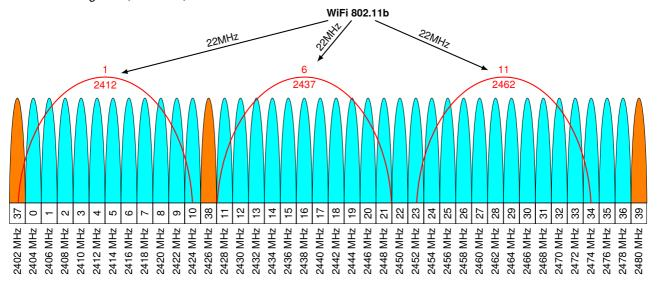
Wifi 802.11b en mode DSSS, des blocs de 22MHz, soient 3 blocs indépendants (sans chevauchement):
