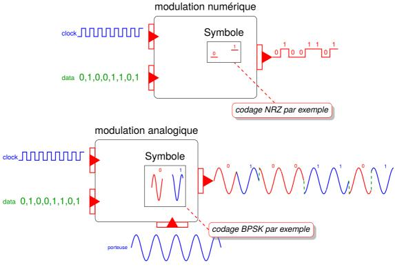
Le **débit** dépend de la **vitesse de modulation**, c-à-d du rythme des transformations réalisées sur la **porteuse**.
