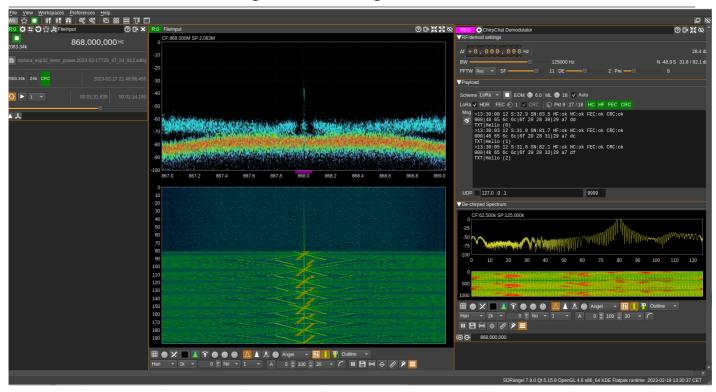
Le logiciel SDRangel permet de démoduler le LoRa pour un SF de 11. Sur cette capture on voit :
