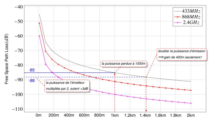
$\Rightarrow$ Un gain de +3dB, peut être **facilement** obtenu avec une **meilleur antenne**!
