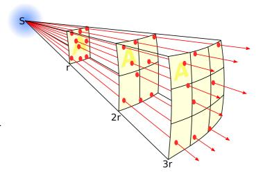
La **puissance du signal** se répartit sur le front d'onde, dont la surface augmente en même temps que la distance depuis la source augmente. C'est pourquoi la **densité de cette puissance diminue** (les lignes de flux issues de la source, en rouge sur le schéma, ont une densité moindre si la distance augmente).
