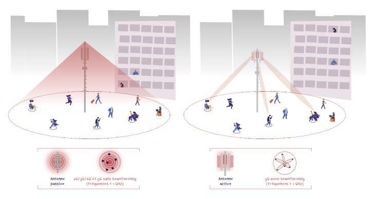
Le «beamforming» permet de «cibler» un utilisateur:
