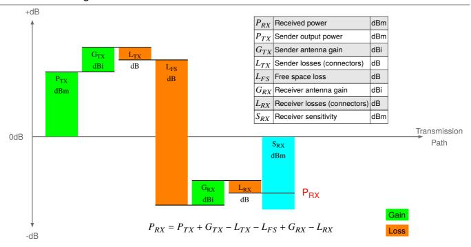
Le «Free Space Loss» est le paramètre qui réduit le plus la puissance reçue par le récepteur.
