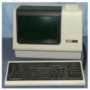
une liaison série, «RS-232», permet d'échanger du texte dans les deux sens (terminal ⇔ mainframe).
