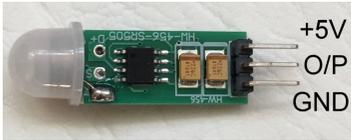
Le capteur PIR est associé à un circuit :
