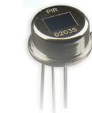
**Capteur PIR** : capteur électronique qui mesure la **quantité de lumière infrarouge** diffusée par les objets dans son champs de vision.
