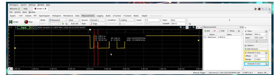
Ici, on voit que  $1/\Delta X = 9,6KHz$  ce qui est le cas : on a configuré le port série pour une transmission à 9600bps :
